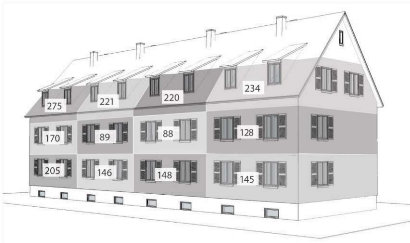
Abbildung 7.7 Jahresheizwärmebedarf des Bestandes in \text{kWh/m}^2\text{a}
